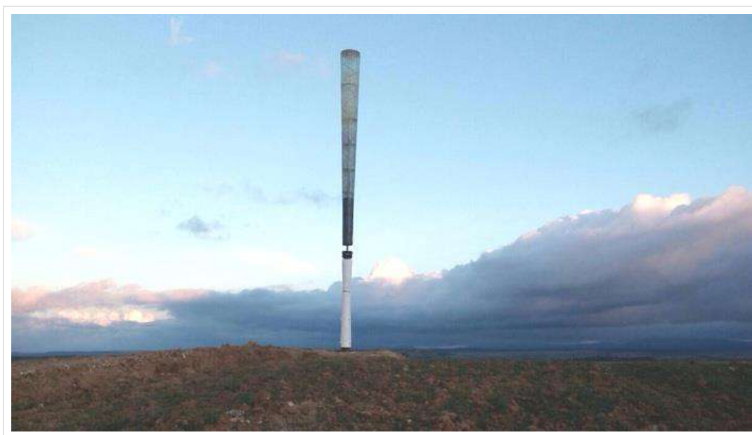
Рисунок 4.25 – Безлопастная ветряная турбина Vortex Bladeless (фото Vortexbladeless.com )
