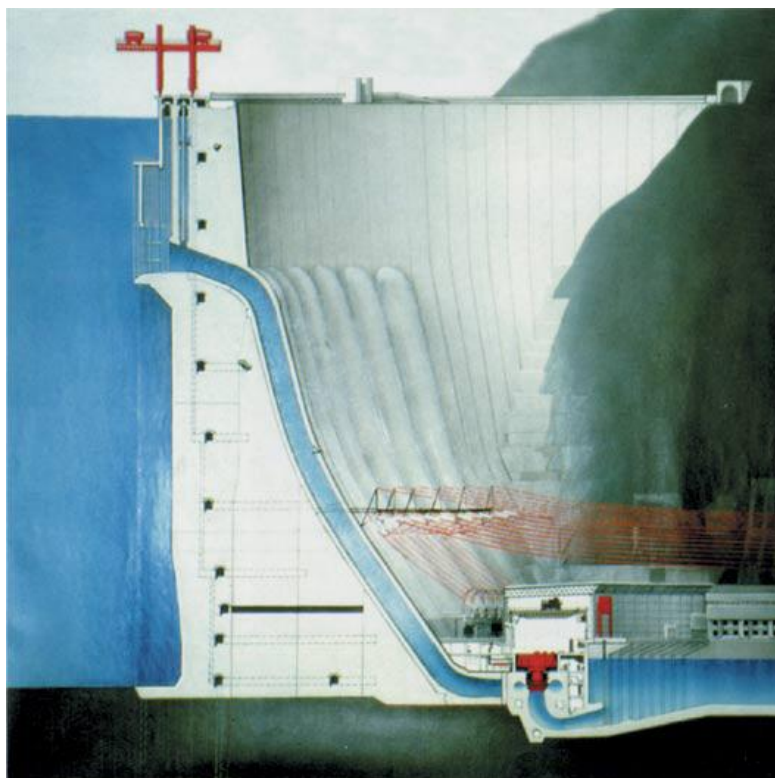
Рисунок 6.4. Разрез по станционной плотине и зданию ГЭС
