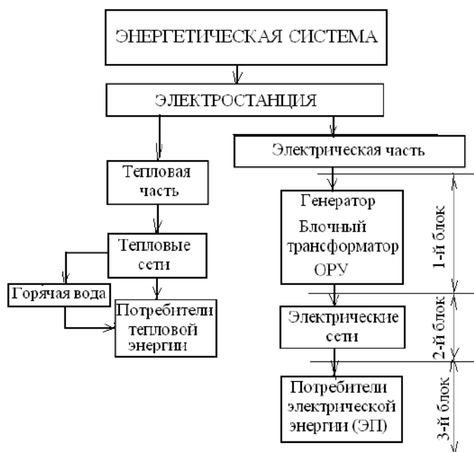
Рисунок 1.1 – Схема системы электроснабжения
