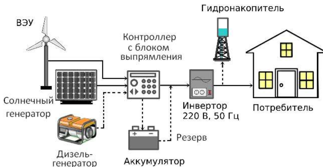
Рисунок 4.21 – Пример ветросолнечной установки для частного дома с резервным дизель - генератором
