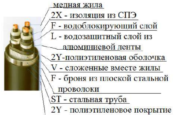
Рисунок 6.19 – Элементы конструкции трехжильных кабелей с СПЭ изоляцией марки 2X(FL)2YVFST2Y на напряжение 132 кВ в стальной трубе
